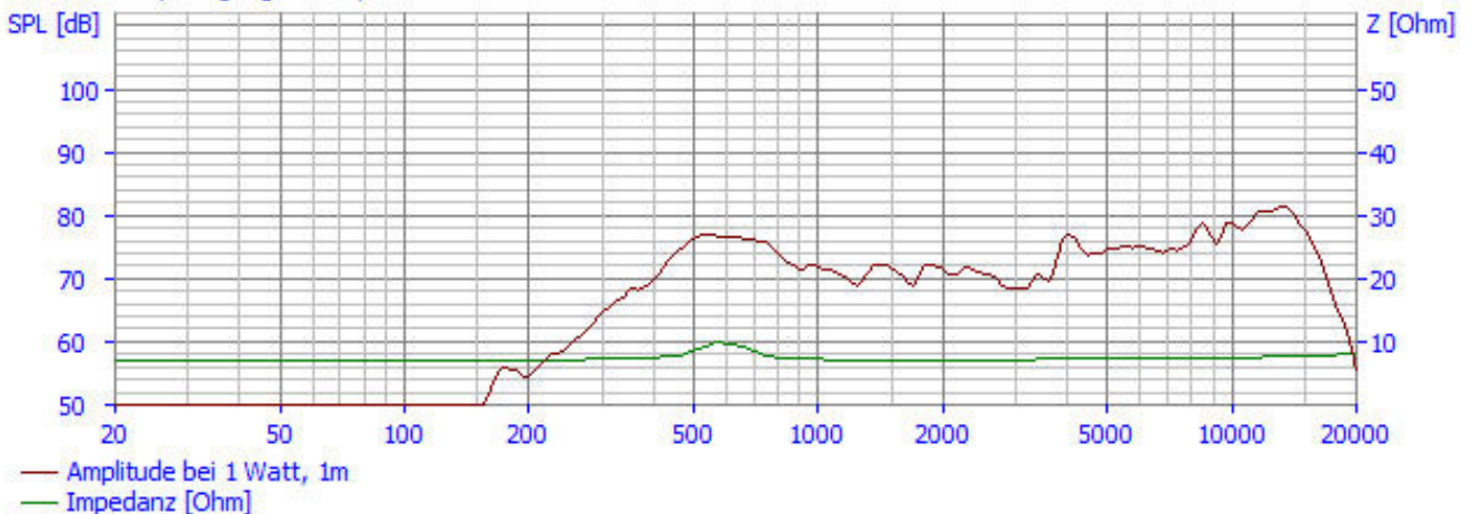
Visaton K 23 SQ - 8 Ohm Frequenzgang und Impedanz
